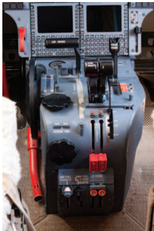
机长在接地后9秒将“减速板”手柄拉到最后的位置，以放出升力卸载系统。
