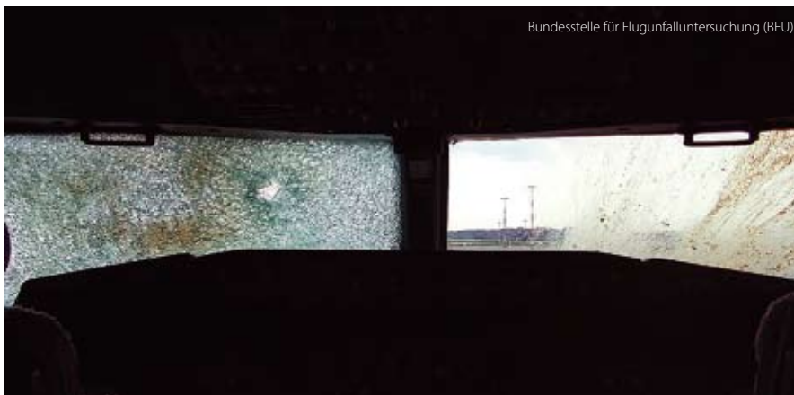
一架柏林航空的737-700在高度2150尺，仪表速度226节时，撞到一群白额雁，图为其碎裂的风挡。
