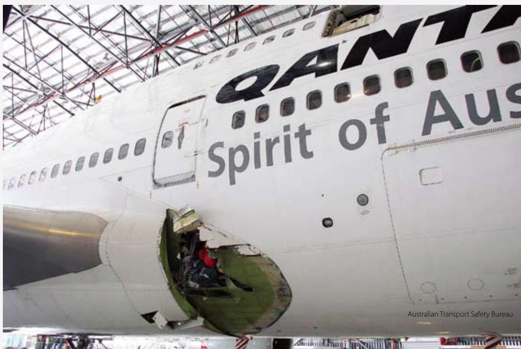
**爆炸将前货舱撕开，并推动氧气瓶向上冲，瓶体在穿透客舱地板之后撞上了门把手并撞坏了客舱顶部的储藏柜。**
