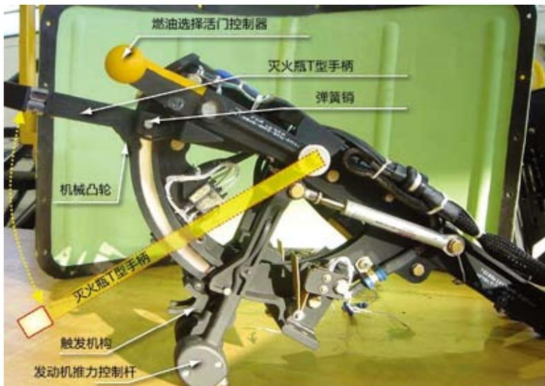
+机型。此次事件中，飞禽没有击穿风挡玻璃，虽然撞击造成风挡玻璃外层裂纹，并支持灭火瓶的T型手柄脱出了卡槽，但这架执行应急医疗服务飞行任务的直升机内的四人没有受伤。
