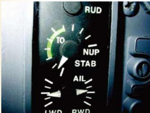
图中显示的这架庞巴迪挑战者600型飞机的俯仰—配平位置指示器和在Teterboro坠毁的飞机上的十分相似。
