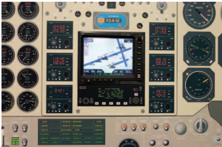
FAA在其位于新泽西州大西洋城的技术中心使用Garmin Apollo MX20多功能显示器演示ADS-B。
