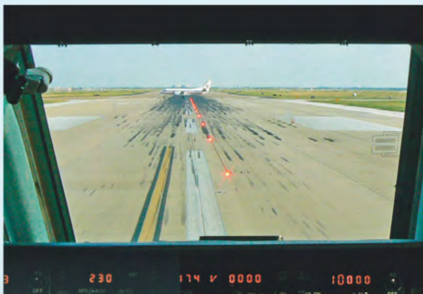
在达拉斯福特沃斯机场，当机组收到管制员发出的允许起飞的指令后，起飞等待灯光向机组发出有飞机正在穿越18L/36R跑道的警告。
