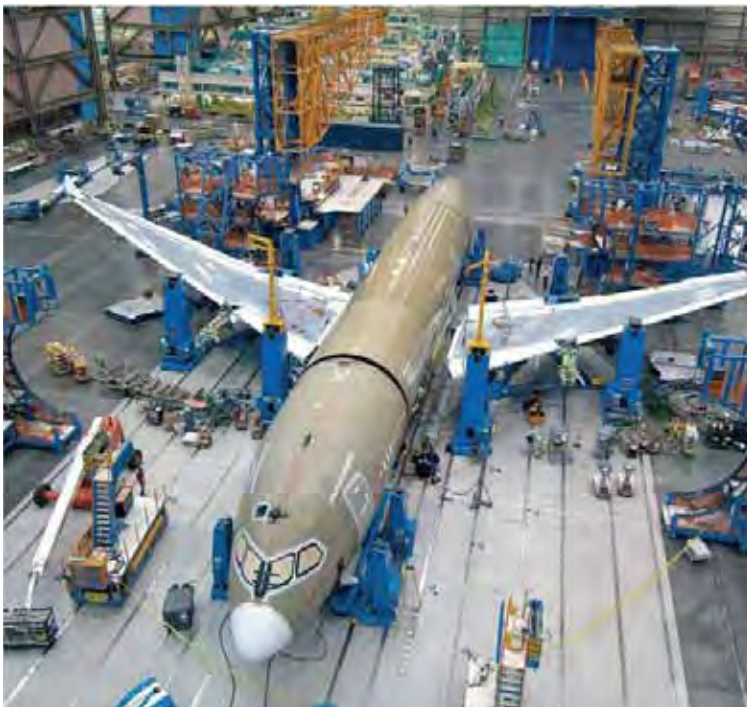
波音787飞机的机身和机翼由复合纤维材料制成
