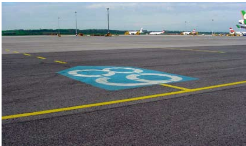
上图：新型“复合机位”滑行引导标志。 下图：旧型“机位号码”标志。
