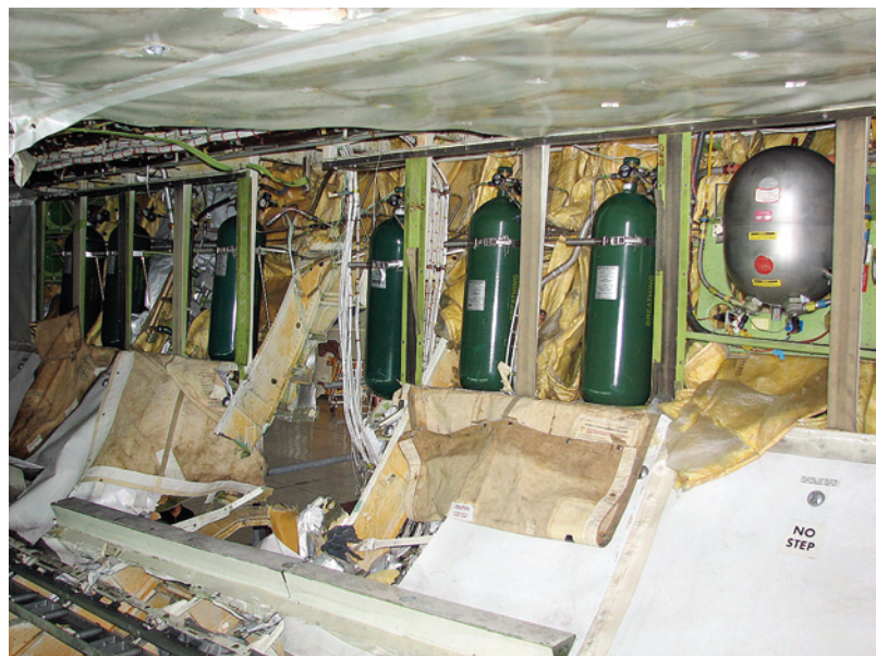
La explosión hizo un boquete en la pared de la bodega de carga delantera y provocó que el tanque saliera despedido hacia arriba, atravesando el piso de la cabina, para luego impactarse contra el marco y la manija de la puerta y los gabinetes superiores.
