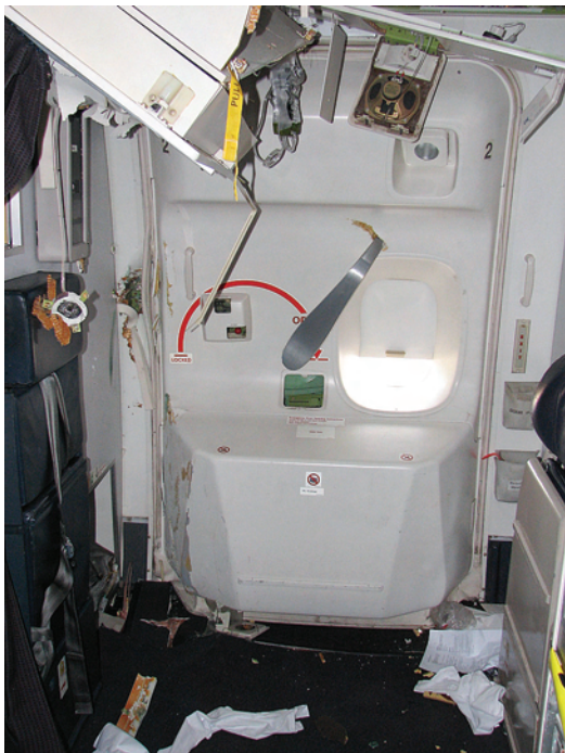
La explosión hizo un boquete en la pared de la bodega de carga delantera y provocó que el tanque saliera despedido hacia arriba, atravesando el piso de la cabina, para luego impactarse contra el marco y la manija de la puerta y los gabinetes superiores.
