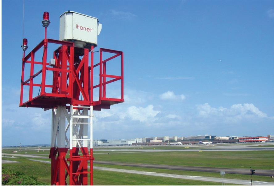
El sistema iFerret de Stratech Systems es un sistema electroóptico que puede usarse para monitorear calles de rodaje y plataformas, además de pistas, en busca de FOD
